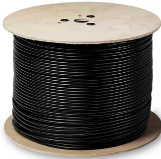
Cable de red exterior CAT 5E con revestimiento de PE negro, rollo de 500 metros compuesto por 4 pares balanceados de 100 ohmios con conductores de cobre rojo flexibles AWG 24. Sus características cumplen con los requisitos de la **Cat. 5E Clase D** hasta 100 MHz, según las normas ANSI/TIA 568.2-D e ISO/IEC 11801. Apto para aplicaciones Gigabit Ethernet (IEEE 802.3ab).
